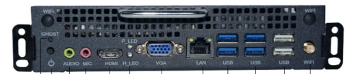
还源键 开关键 麦克风 音频接口 HDMI LED灯 VGA LAN USB3.0 USB2.0 WIFI
